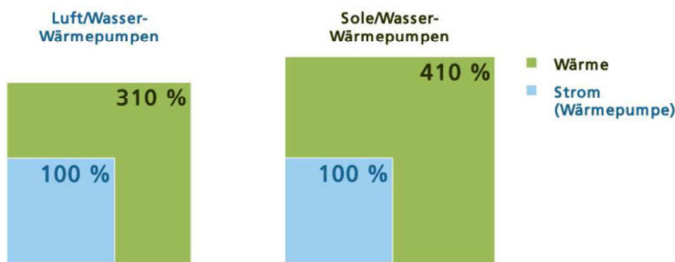
Abbildung 65: Effizienz der Wärmepumpensysteme im Altbau. Ergebnisse aus dem Projekt „WPsmart im Bestand“ 34
