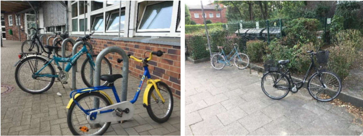
Abbildung 98: Radabstellanlagen im Projektgebiet: Anlehnbügel an der James-Krüss-Schule (links) und Bodenbügel an der Bücherei (rechts). (Quelle: ZEBAU GmbH)
