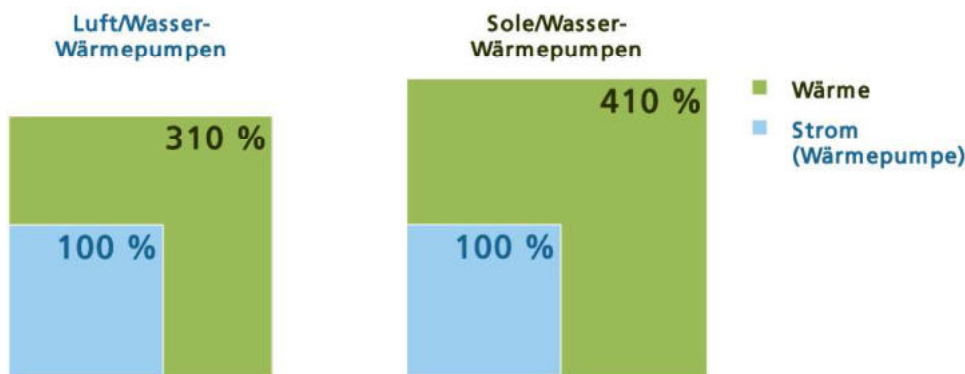
Abbildung 67: Effizienz der Wärmepumpensysteme im Altbau. Ergebnisse aus dem Projekt „WPsmart im Bestand“ 35
