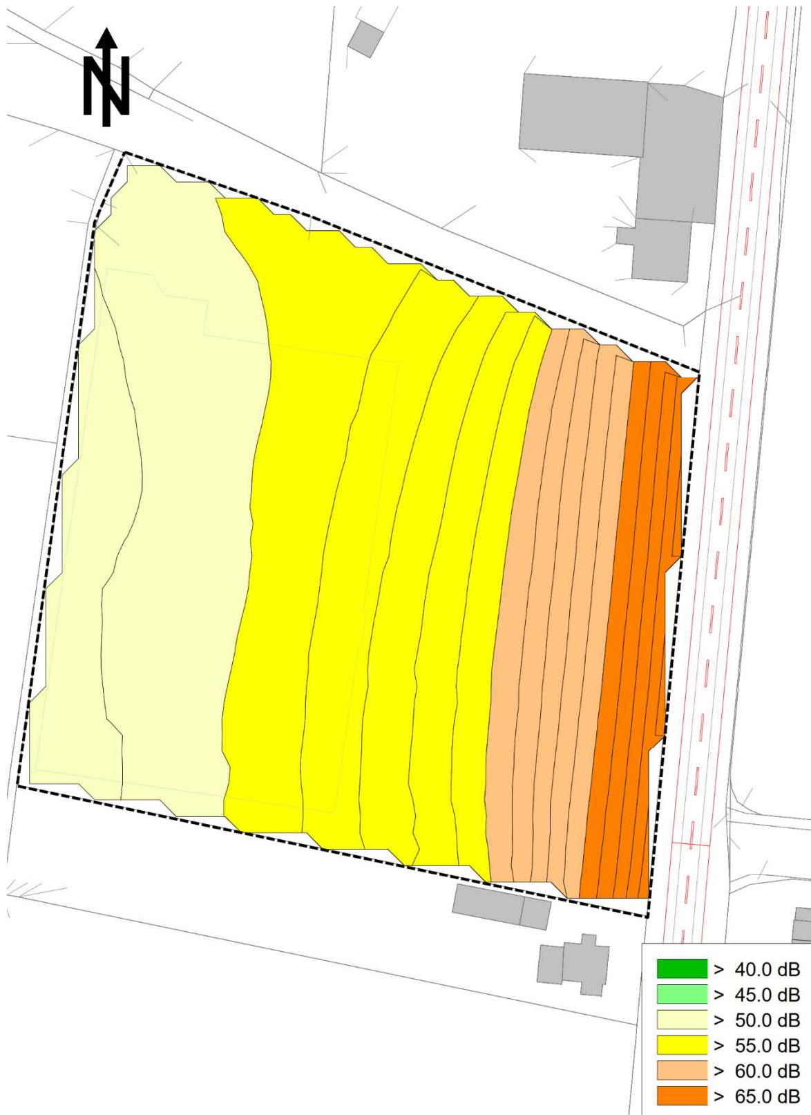
Abbildung 7 - Maßgeblicher Außenlärmpegel für schutzbedürftige Räume
