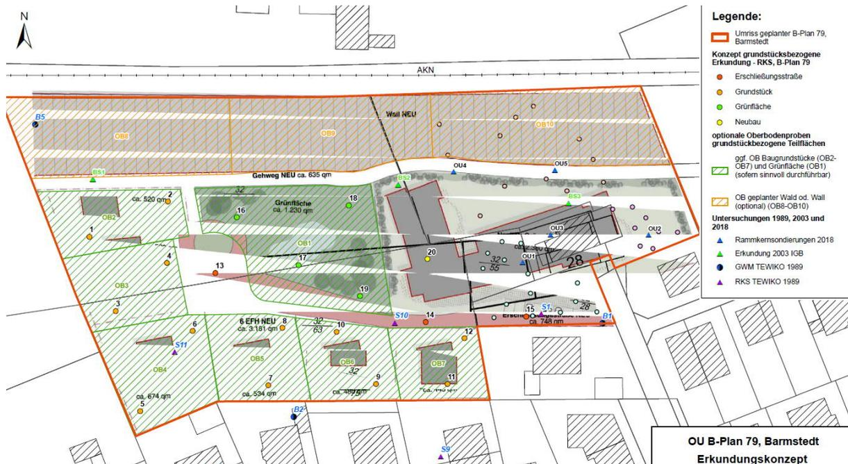
Abbildung 23 -Lage der Sondierungspunkte und der Bodenprobenahmestellen im Plangebiet
