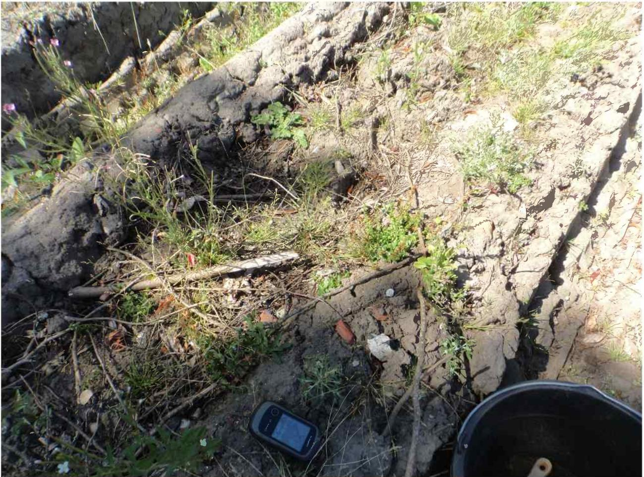
Foto 1: Oberflächennahe Bauschutt- und Ziegelreste im südlichen Bereich nahe RKS5
