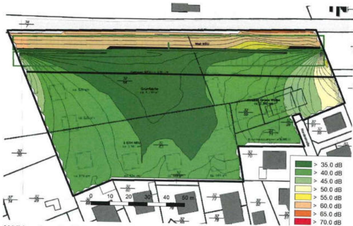
Abbildung 6 - maßgeblicher Außenlärmpegel für schutzbedürftige Räume mit Lärmschutzwall
