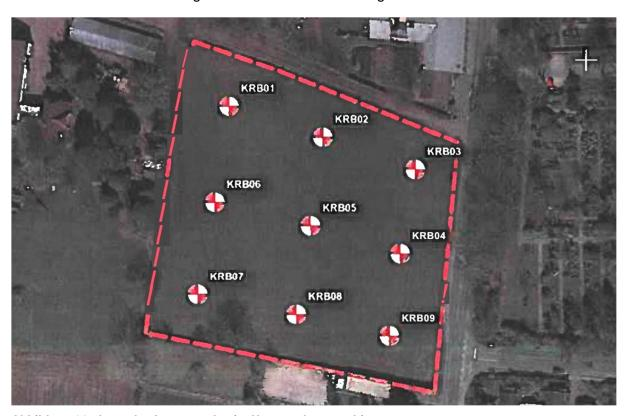
Abbildung 21 - Lage der Ansatzpunkte im Untersuchungsgebiet
