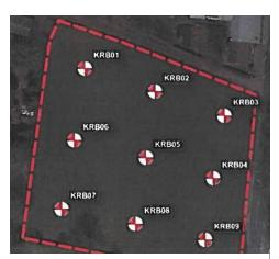
Abbildung 16 - Lage der niedergebrachten Sondierungsbohrungen im Plangebiet
